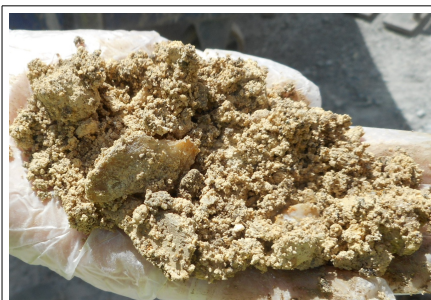
Remblais à débris calcaires
